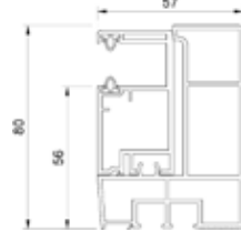
Einseitige Führungsschiene (PVC) - RS Revision von außen. MK933 + MK9760
